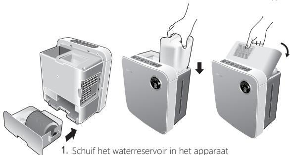
1. Schuif het waterreservoir in het apparaat
