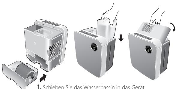
1. Schieben Sie das Wasserbassin in das Gerät
